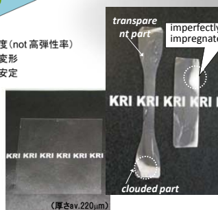
ナノファイバー層をラミネートした 積層フィルム (PA樹脂)
