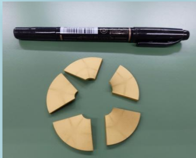
特殊扇形形状 TiN処理Nd磁石 用途：横浜国大 藤本先生 Spiral Motor
